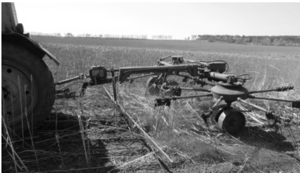
Рис.2 – Робота роторних грабель ГВР-6 зі зламуючим брусом на зламванні та згрібванні трести конопель весняного збирання у валок
